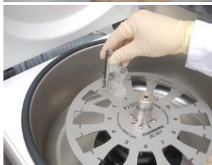
3.6) Coloque o Megafunil montado na Cito Centrífuga
